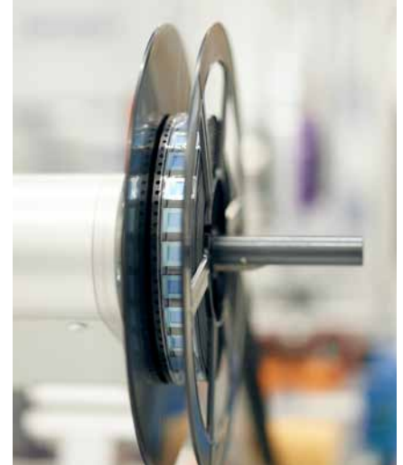
Nachdem die Chips geprüft worden sind (links), werden sie verpackt. Grössere rollt eine Maschine ähnlich wie eine Filmrolle auf (oben).
