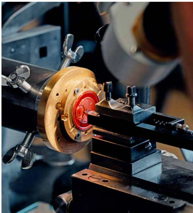
Das Zifferblatt einer Voutilainen-Uhr besteht aus vier Komponenten. Jede einzelne Linie darauf wird mit dem Gravierstichel gezogen – unter dem Binokular und auf historischen Guillochiermaschinen.
