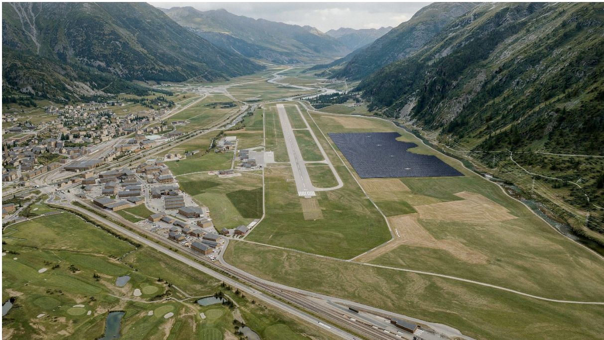
Abbildung 1 Rendering Luftaufnahme des Solarkraftwerks Samedan zwischen Flughafen Samedan und Flaz (bergseitig, parallel zu Hochspannungsleitungen). 6.5m Reihenabstand der Modulreihen erlauben Mehrfachnutzung des Landes.
